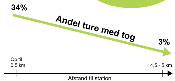
Andelen af ture, hvor personer vælger tog, falder med personens afstand til nærmeste station. Her illustreret for summen af afstande i turens to ender. Egen bearbejdet data præsenteret fra Transportvaneundersøgelsen 2016-2021.
