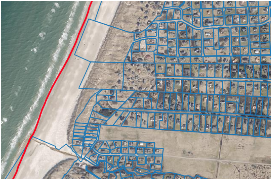
Illustrationen viser hvordan kystlinjen (rød) kan afvige fra den matrikulære afgrænsning (blå) mod kysten – både positivt og negativt.
